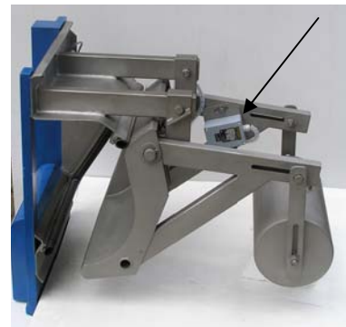
Alløbsklap med påmonteret analog vinkelføler . Afløbsmængden kan registreres via omregning i PLC
